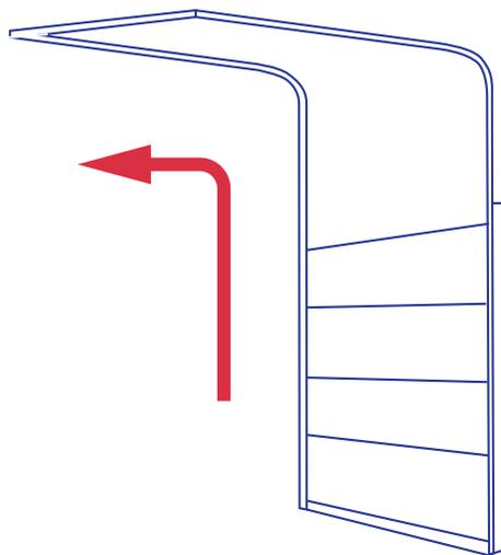
A linha seccionada modelo HL é composta por painéis de aço galvanizado com revestimento em poliuretano (PU), o que proporciona maior resistência e conforto termoacústico. Sua estrutura mantém a porta, quando aberta, suspensa em posição vertical e horizontal.
