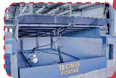
**NIVELADORA ELETRO HIDRÁULICA EMBUTIDA**
